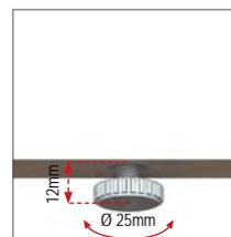
Vérins de réglage en polyuréthane, diam. 25 mm, réglage de 0 à 12 mm.
