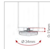
Vérins de réglage pied intermédiaire en PE, diam. 34 mm, amplitude 0-15 mm.
