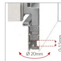
Vérins de réglage en PE, diam. 20 mm, amplitude 0-15 mm.
